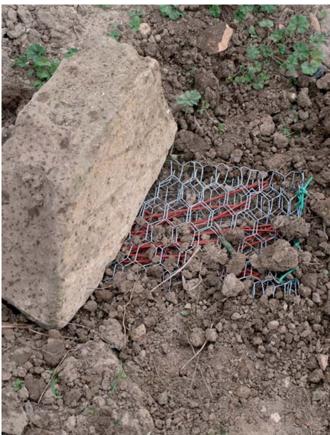
Comprobación del nivel de degradación de los difusores al aire libre y enterrados. Colocación de difusores en superficie (izquierda) y enterrados a 5-10 cm (derecha).
