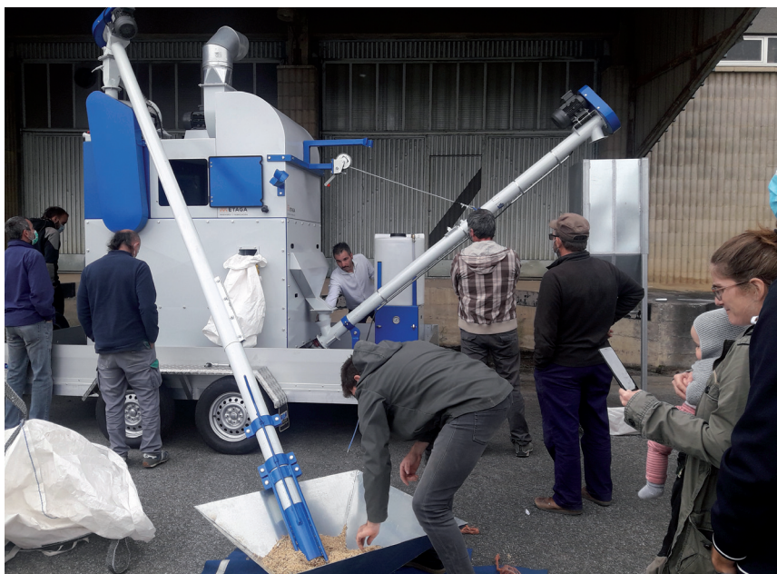
Con el proyecto, se ha adquirido un equipo móvil de limpieza de grano, apto para una gran variedad de granos, y se ha dado formación sobre su funcionamiento.
