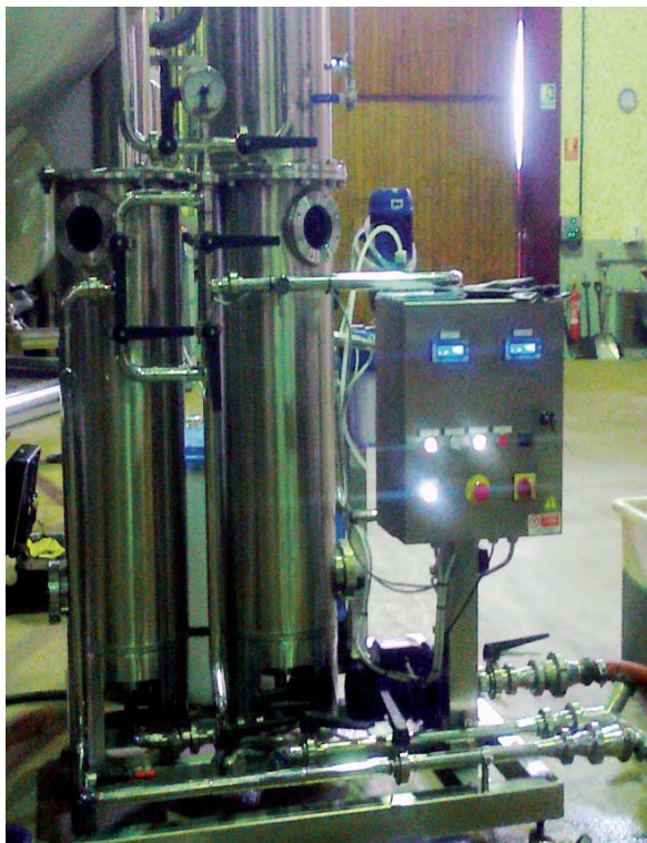
Equipo Mod. ISR 2000-D para estabilización mediante resinas. Fuente: http://www.acenologia.com/AEB/pdf/isr.pdf
