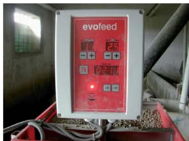
Detalle del aparato electrónico que controla la tolva.
