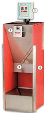
Detalle del aparato electrónico que controla la tolva.
