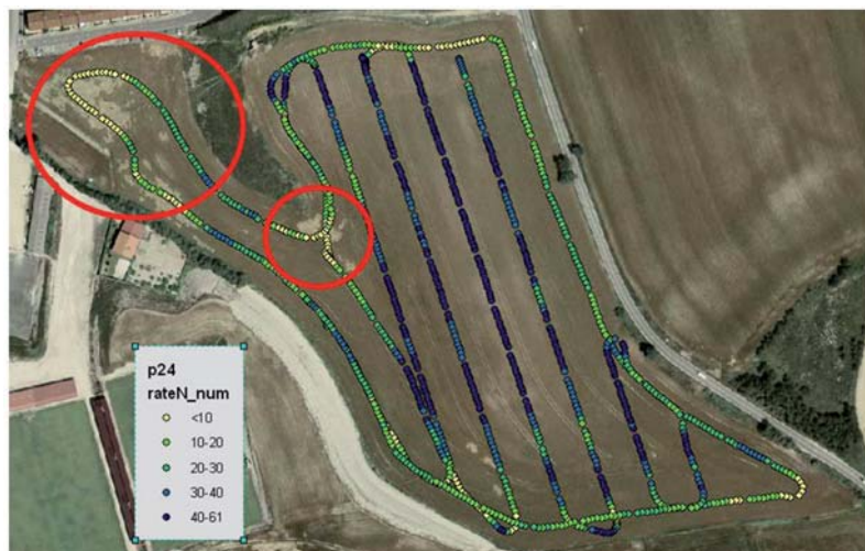
Figura 4. Ejemplo de las distintas lecturas realizadas por el sensor en una parcela.
