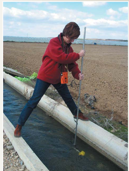
Medición del caudal de riego con molinete hidráulico.
