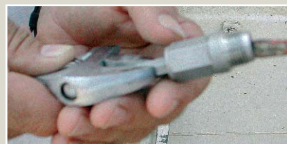
4.- Se suelta el pulsador con ayuda de llave y destornillador.
