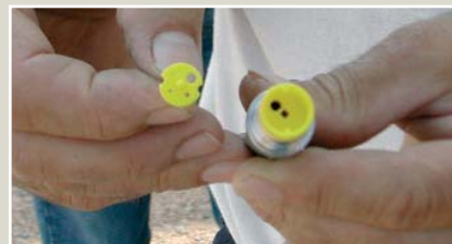
3.- Se desmonta y limpia el mecanismo de paso de agua.
