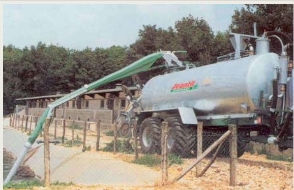
Brazo de bombeo superior
