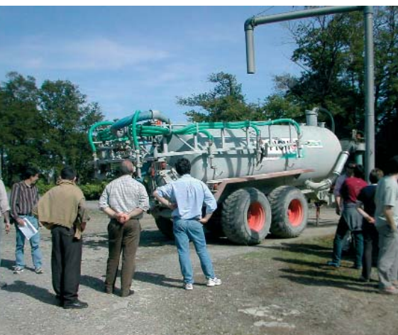
Cuba de purines equipada con rampa de reparto multibocas y sistema de carga desde el foso.
