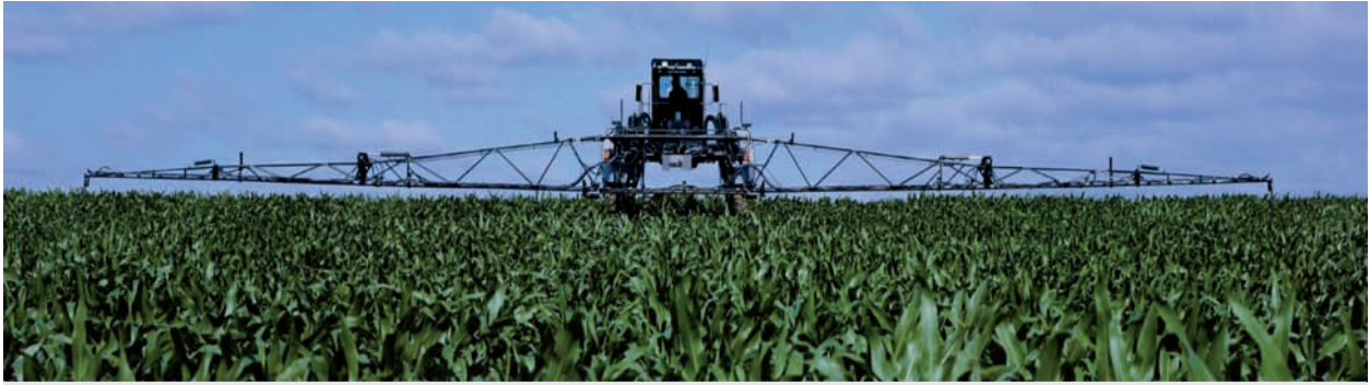
El guiado con GPS permite ahorrar insumos y carburante, evita solapamientos en las pasadas y ahorra tiempo.
