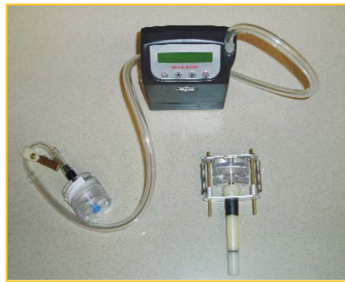
■ FIGURA 1: BOMBA DE SUCCIÓN BUCK-GENIE VSS-5 CON DISPOSITIVOS DE CAPTACIÓN DE POLVO.
