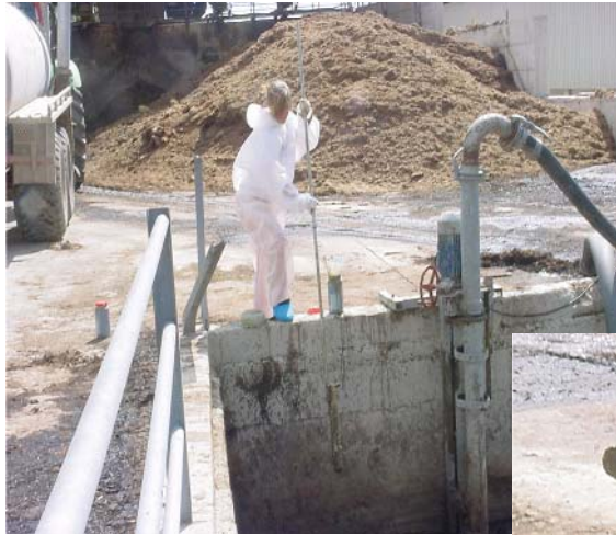
Foto 1 (superior) Recogida de purín en fosa. Foto 2 (derecha) Filtrado y toma de muestra.
