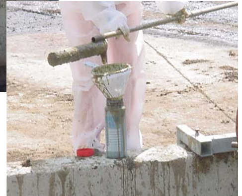
Foto 1 (superior) Recogida de purín en fosa. Foto 2 (derecha) Filtrado y toma de muestra.
