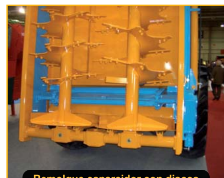
Remolque esparcidor con discos de reparto en la base de salida y puerta reguladora de caudal.
