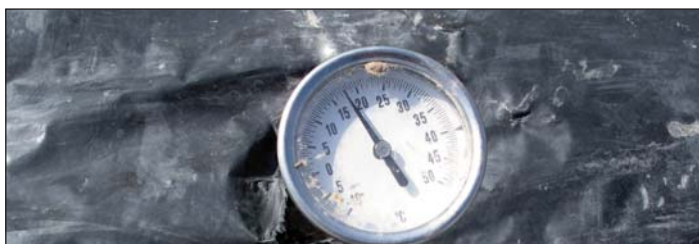
Termómetro de suelo para medir temperatura de caballón a nivel de yemas
