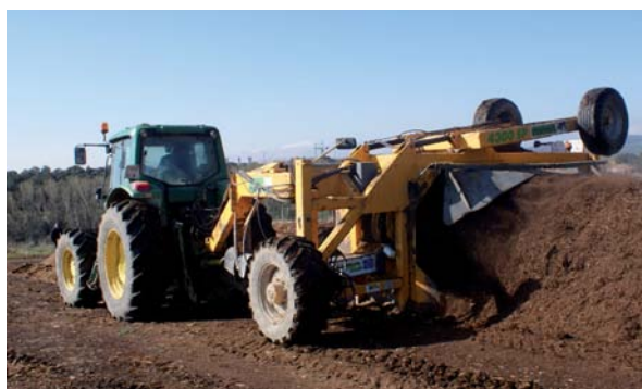
La volteadora trabajando
