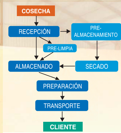
Figura 2. Diagrama de flujo en una cooperativa o almacén de cereales
