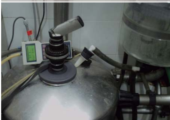
Medición del caudal de la reserva durante la revisión del equipo de ordeño
