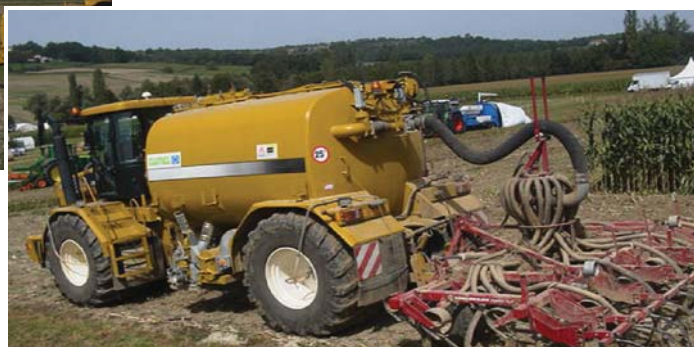
En la fotografía inferior, cisterna y equipo de enterrado de purines de dicha CUMA.
