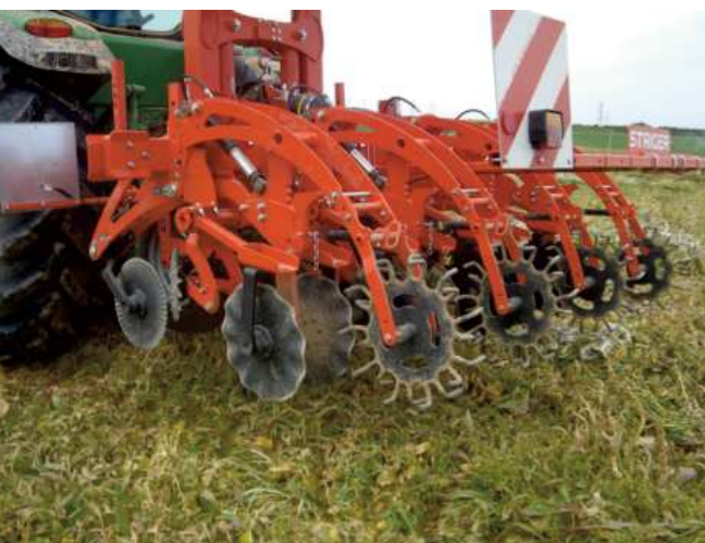
En las demostraciones de INTIA se han utilizado los típicos chasis con elementos para hacer la labor en banda, tal y como puede apreciarse en las imágenes superiores. Foto 1 (izquierda): Striger de Kuhn y Foto 2 (derecha): Cebra de Maschio-Gaspardo
