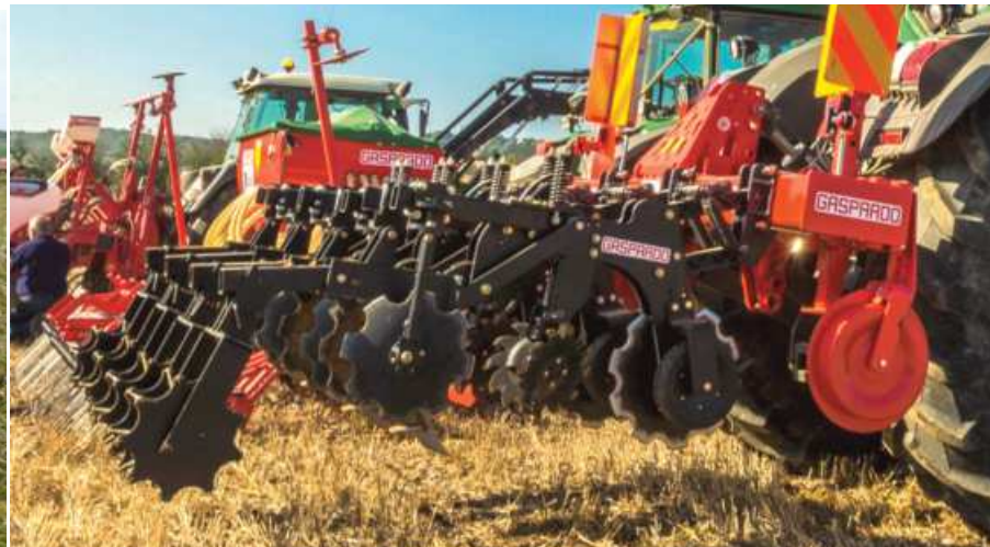
En las demostraciones de INTIA se han utilizado los típicos chasis con elementos para hacer la labor en banda, tal y como puede apreciarse en las imágenes superiores. Foto 1 (izquierda): Striger de Kuhn y Foto 2 (derecha): Cebra de Maschio-Gaspardo
