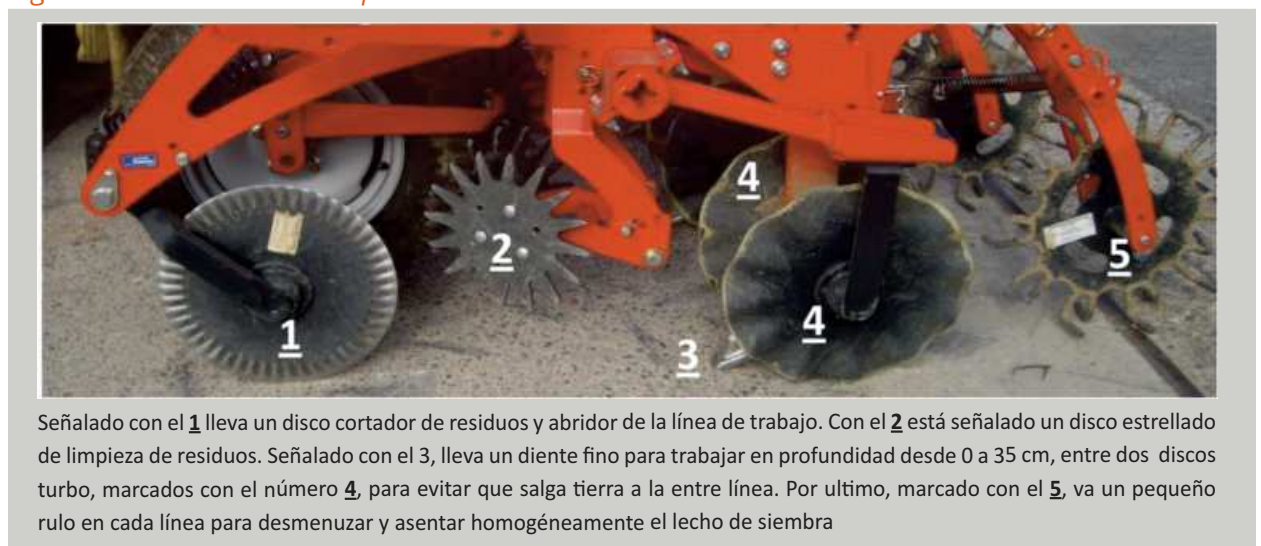
Figura 1. Elementos del strip tiller
