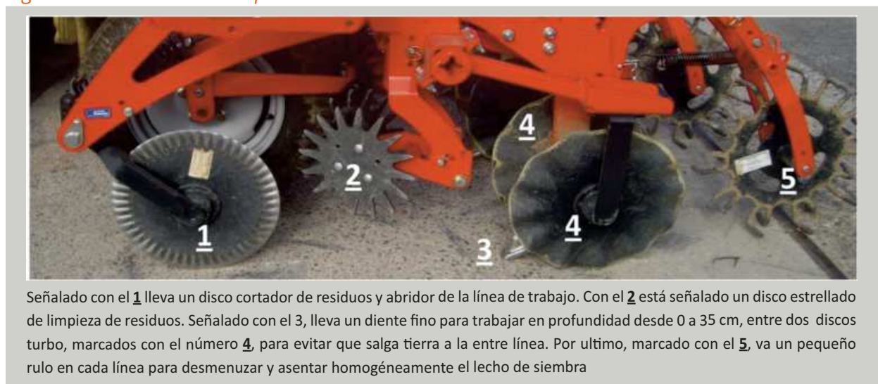
Figura 1. Elementos del strip tiller
