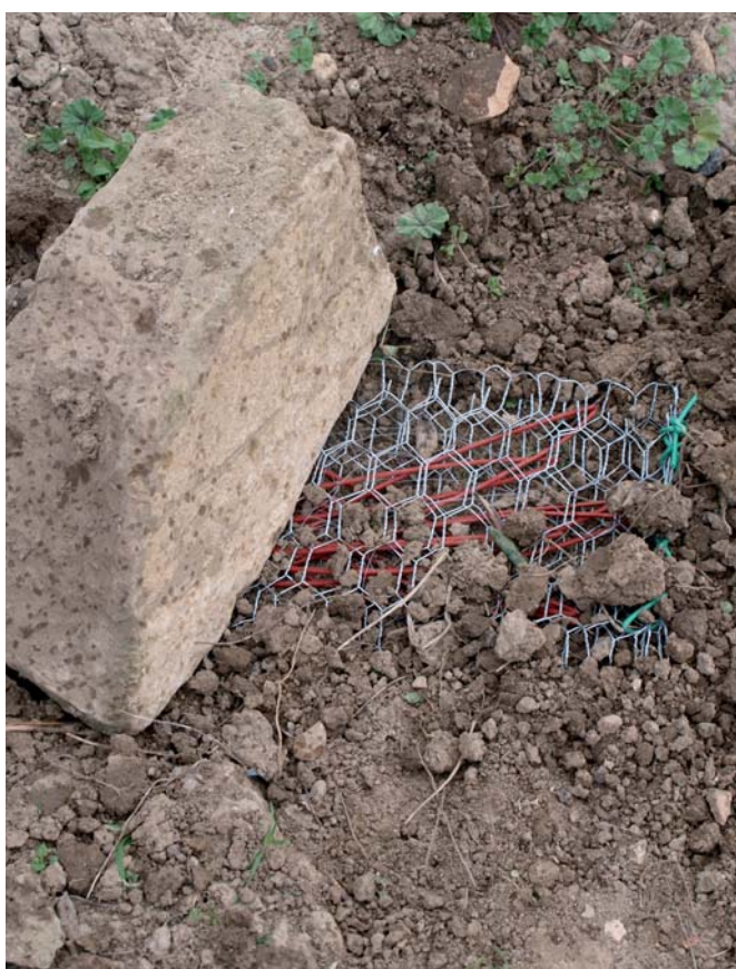
Comprobación del nivel de degradación de los difusores al aire libre y enterrados. Colocación de difusores en superficie (izquierda) y enterrados a 5-10 cm (derecha).
