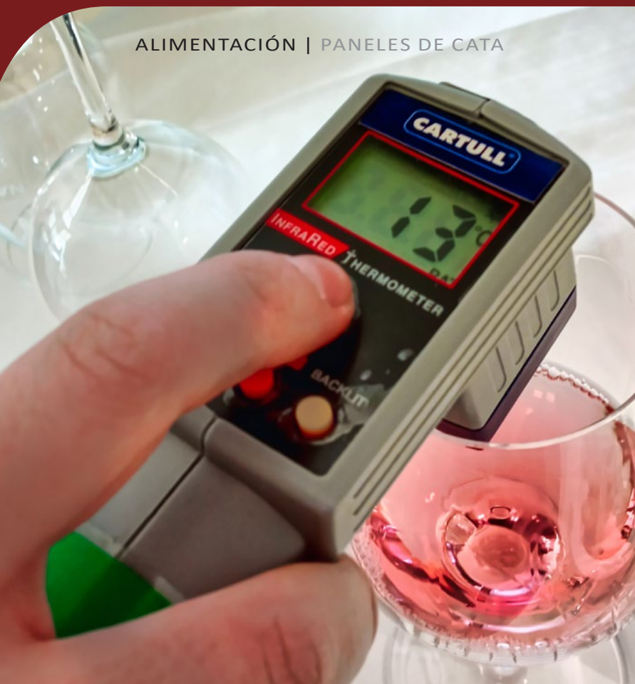
Medida de t^{\circ} , previa a la cata, de un vino rosado (termómetro infrarrojo).
