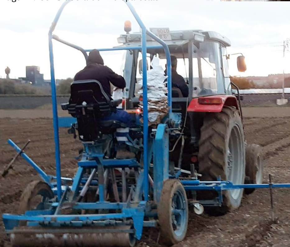
Imagen 4. Sembradora de microparcels
