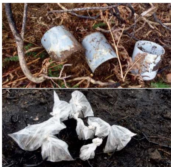
Muestras de suelo recogidas en cilindros a dos profundidades y embolsadas y etiquetadas para su traslado a laboratorio. Fotografías: Rosa María Canals
