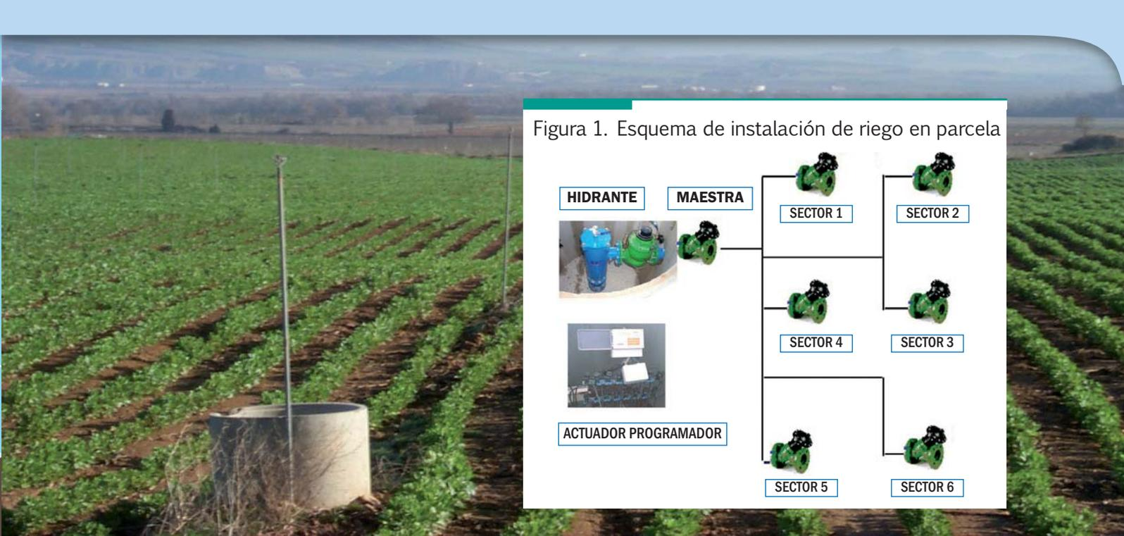
Figura 1. Esquema de instalación de riego en parcela
