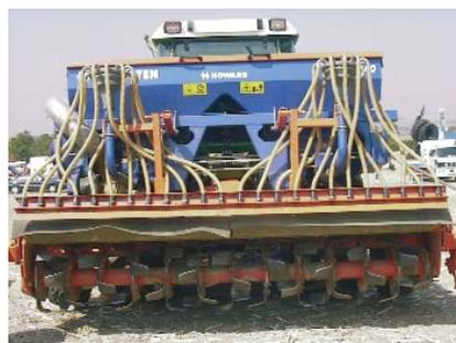
Sembradora rápida con rotocultor y siembra a voleo.
