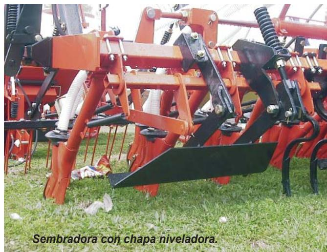
Sembradora con chapa niveladora.
