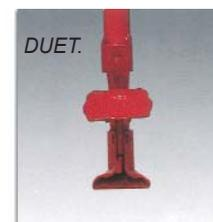
**El disco:** El surco lo abre un disco mediante un corte longitudinal producido por su giro. El disco puede ser sencillo ó doble. La semilla es depositada en el surco por la parte lateral si es sencillo y entre ambos si es de doble disco. Estos tipos de disco se emplean principalmente en las sembradoras de siembra directa.
