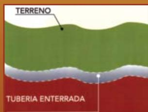
Se consigue un drenaje perfecto evitando las obstrucciones en el tubo, al introducir éste y la grava pretensando la tierra y mantener una inclinación constante controlada por láser. Además, el sistema utilizado por “AHI VA
