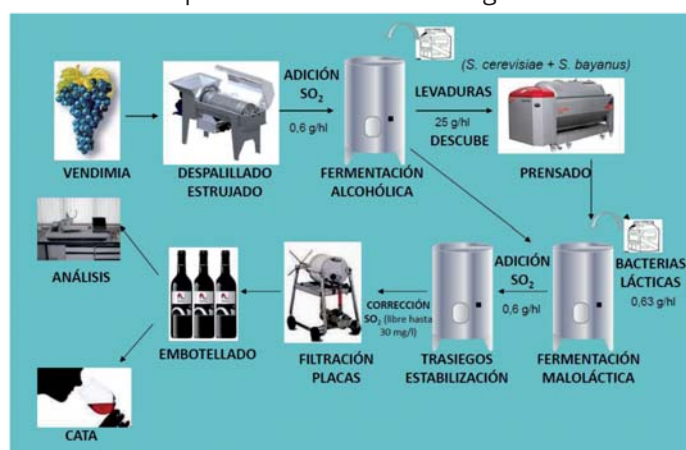
Gráfico 2. Diagrama del proceso de elaboración de los vinos tintos experimentales en la bodega de EVENA
