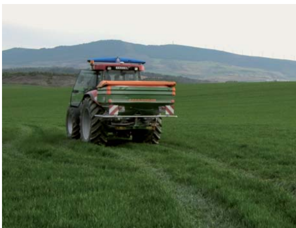
Abonadora de dosificación variable acoplada a sistema N SENSOR para fertilización ON TIME.
