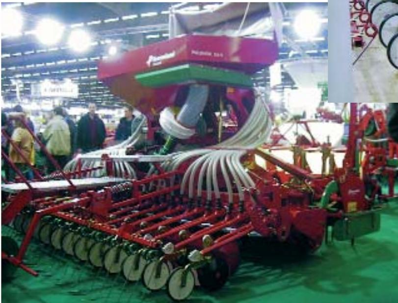
*En estas dos últimas fotografías se aprecian dos máquinas expuestas en la Feria: en concreto dos sembradoras de precisión.*
