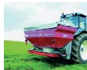
ajustes y la vigilancia de las lindes; con arquitectura adaptada a la agricultura razonada. Puede esparcir entre 12 y 36 metros, según las diferencias de presión en cada motor hidráulico de arrastre de los discos esparcidores.
