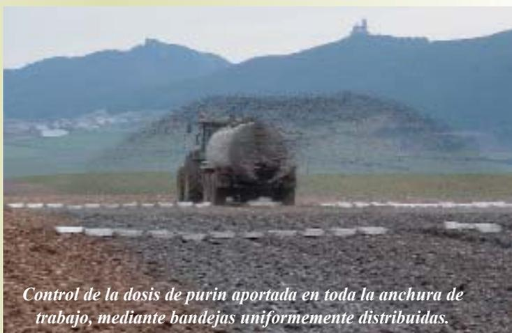
Control de la dosis de purin aportada en toda la anchura de trabajo, mediante bandejas uniformemente distribuidas.
