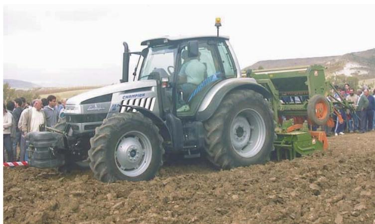
*Tractor con equipo combinado sembradora + grada rotativa a la toma de fuerza.*
