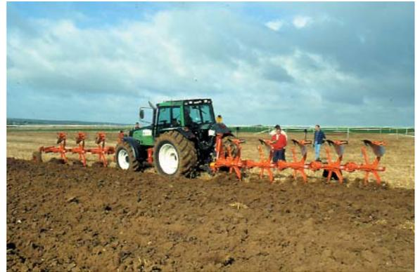
*Tractor realizando labor profunda con arados de vertederas adelante y atrás*
