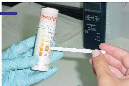
**Material:** varillas de ensayo impregnadas con 3,5 mg de tetraiodomercurato potásico (reactivo de Nessler). Reactivo para la alcalinización de la muestra, tubos de ensayo y patrón colorimétrico.
