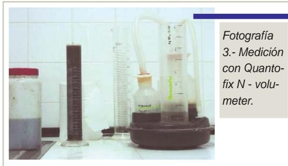
Fotografía 3.- Medición con Quantofix N - volumeter.
