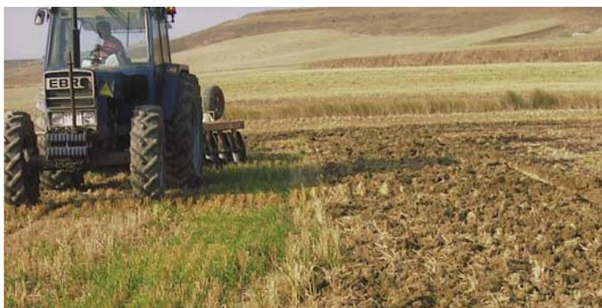
**Para los trabajos de tracción ligeros**, el motor debe ofrecer un par elevado a bajo régimen de vueltas por minuto. La caja de cambios tendrá una adecuada gama de velocidades comprendidas entre 10 y 25 km/h. Se tendrá muy en cuenta la maniobrabilidad del tractor en cuanto a distancia entre ejes, radio de giro, puentes delanteros, y también inversor sincronizado.
