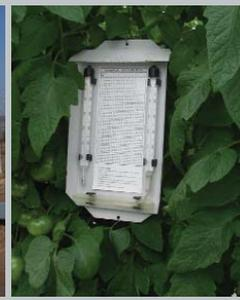
Las estructuras bajas ofrecen mayores dificultades para lograr un buen manejo climático que las estructuras altas (foto central). Es fundamental contar con aparatos indicadores de humedad y temperatura en el interior.
