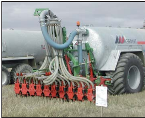
Máquinas de reparto de purines con brazos colgantes y reja de enterrado, disminuyen el tiempo y superficie de contacto purín-aire.
