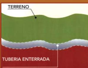
Se consigue un drenaje perfecto evitando las obstrucciones en el tubo, al introducir éste y la grava pretensando la tierra y mantener una inclinación constante controlada por láser. Además, el sistema utilizado por “AHI VA
