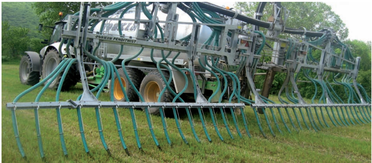
Se utilizó un equipo de tubos colgantes para aplicar los materiales del ensayo, que minimiza las pérdidas de N amoniacal por volatilización.
