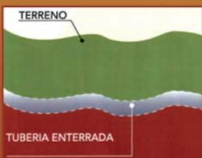
Se consigue un drenaje perfecto evitando las obstrucciones en el tubo, al introducir éste y la grava pretensando la tierra y mantener una inclinación constante controlada por láser.
