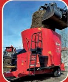
Caja de perfil poligonal para un segundo corte rápido de las pacas enteras de heno y hierba cortada.
