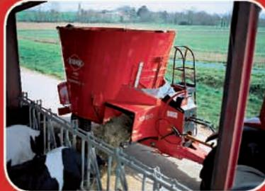
Desplazamiento lateral hidráulico de la cinta para una distribución adaptada a todos los comederos.
